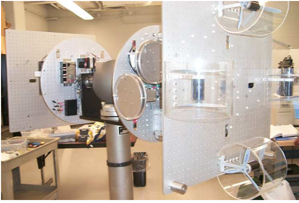
Fig. 2. Fan Thruster Assembly on TACT
