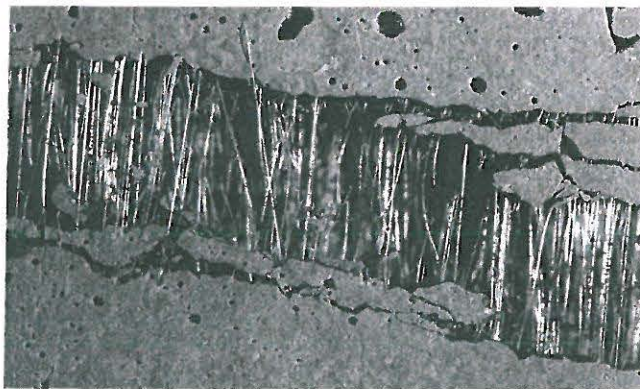
Kunststofffasern in biegsamem Beton hindern die entstehenden Mikrorisse daran, sich zu verbreitern (links; der abgebildete Bereich ist etwa fünf Millimeter breit). Sie haben einen gleitfördernden Überzug, so dass sie sich zunächst ein Stück aus der Zementmatrix herausziehen lassen. Dabei wird jedoch die Gleitschicht abgeschabt (rechts). Der Abrieb sorgt dann zusammen mit dem gut haftenden Inneren dafür, dass die Fasern verkanten und stecken bleiben.
