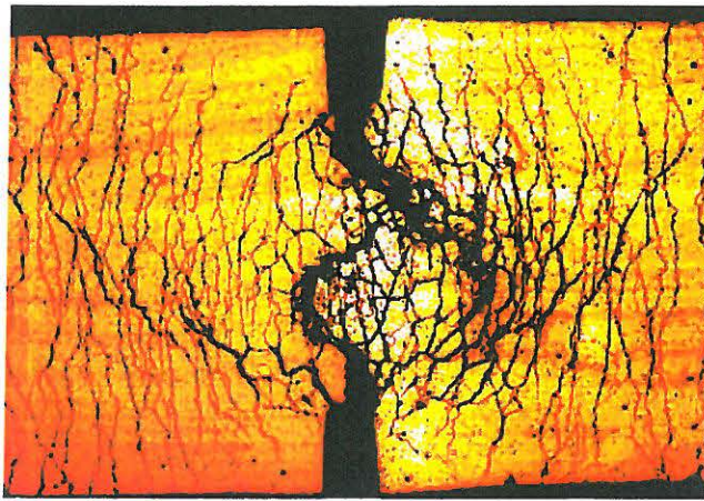
Biegsamer Beton verträgt auch Kerben, ohne zu zerspringen. Wie diese eingefärbten Aufnahmen zeigen, bildet sich rund um die Kerbspitze ein Hof von Mikrorissen. Diese verteilen die Spannung weiträumig. So verhindern sie, dass sich von der Kerbe aus ein breiter Riss quer durch das Material ausbreitet.
